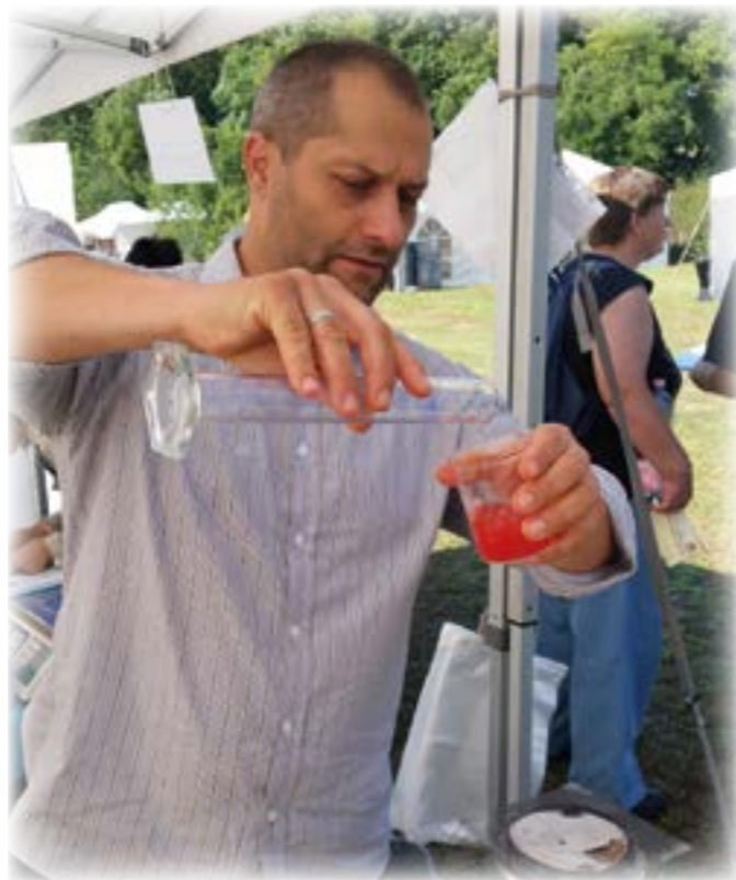
A Biokontroll Hungária Nonprofit Kft. munkatársa zöldség mintákból nitrát tartalom mérést végez
