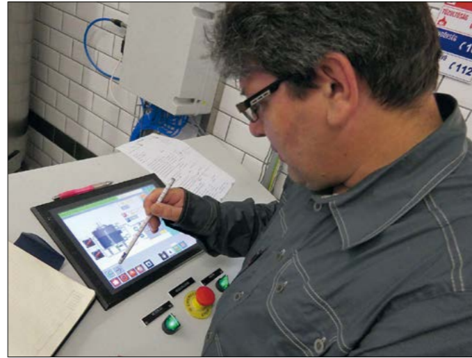
A receptúra rögzítése PLC-n
